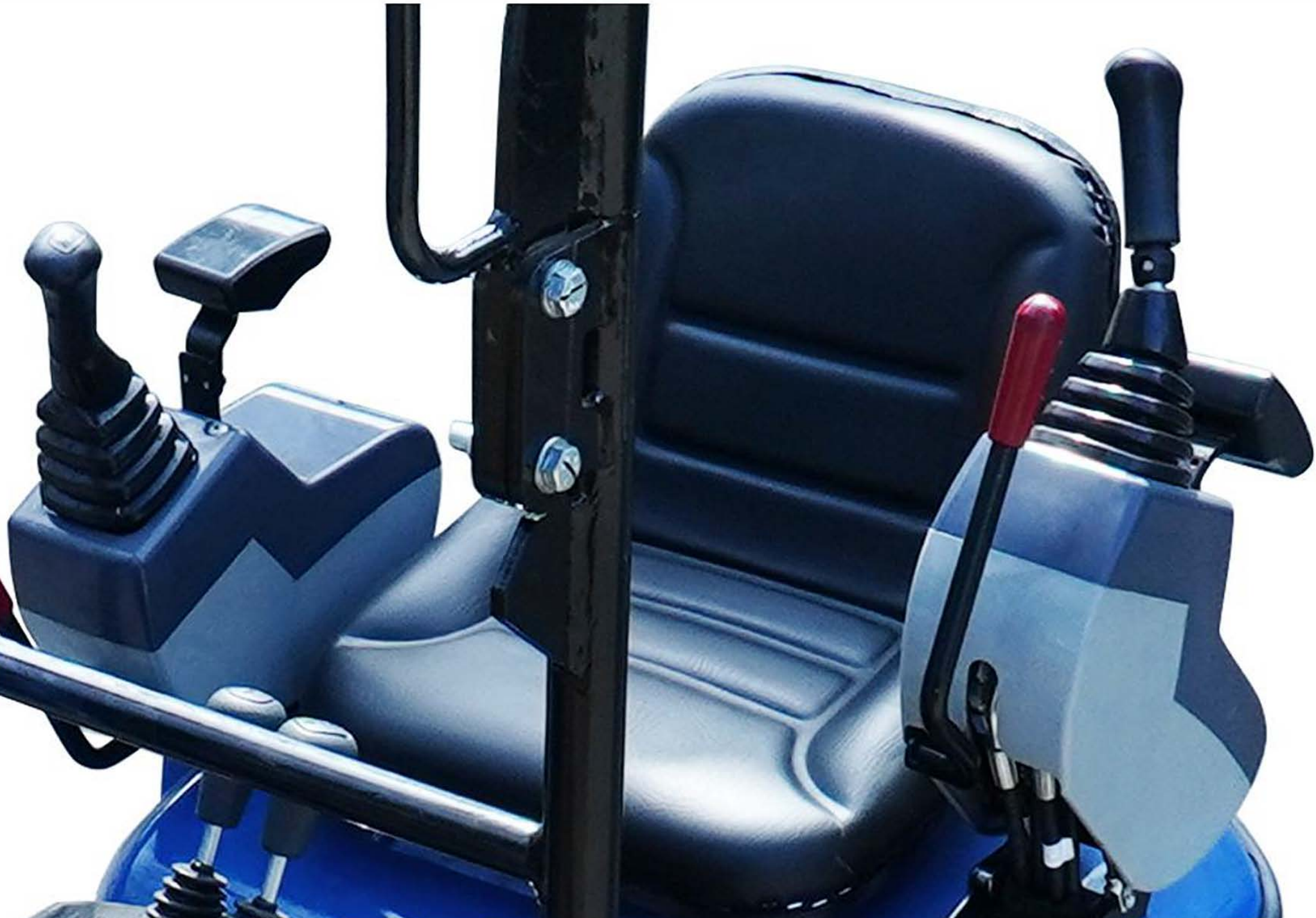
Выдвижное сиденье и втягиваемый ремень безопасности Выдвижное сиденье регулируется в четыре этапа в соответствии с комплекцией оператора, что позволяет ему работать в удобном положении, * При использовании системы ROPS будьте уверены во время работы
