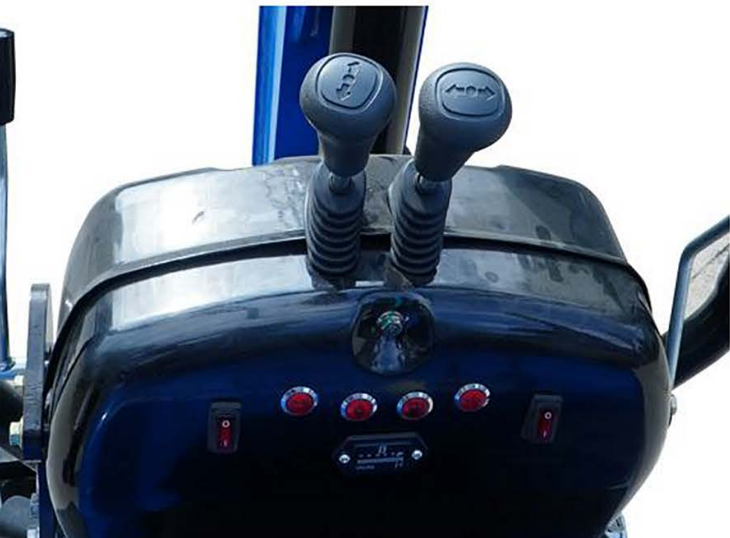
1 Передний рычаг управления Установленный спереди рычаг управления обеспечивает достаточно места для ног и вокруг сиденья водителя.
