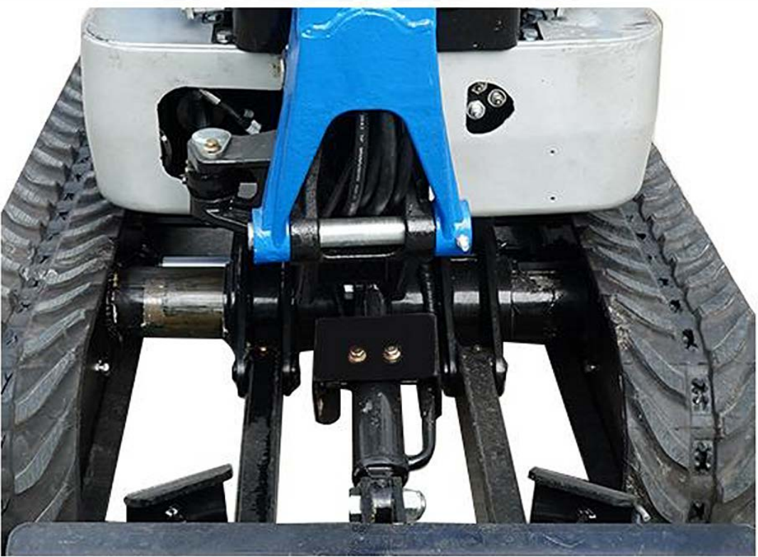
8 Разъемный бульдозерный шланг в случае непредвиденного повреждения шланг можно легко заменить.
