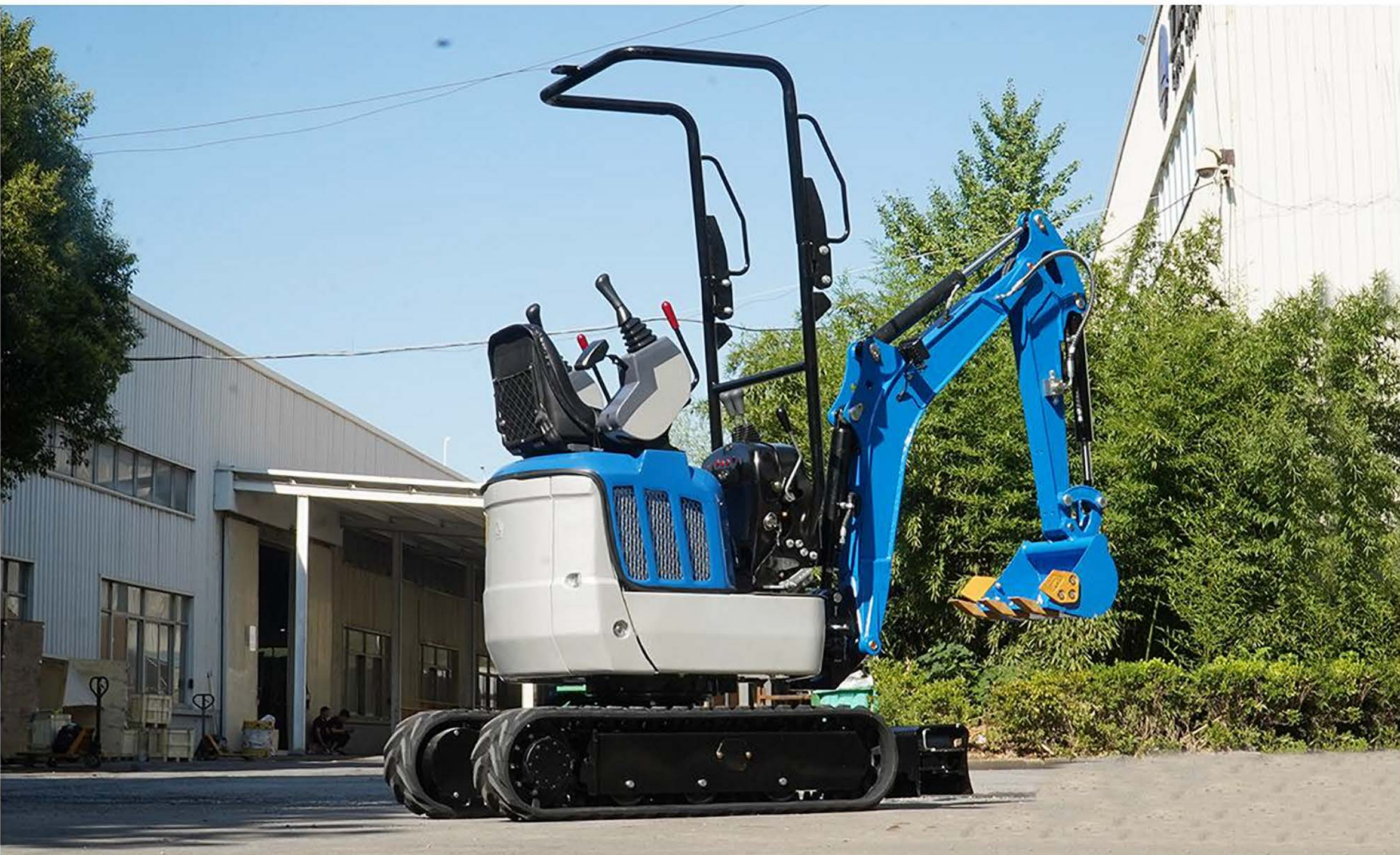
Цилиндр стрелы, установленный сзади Вы можете зачерпывать ковшем крупные камни или куски бетона, загружать их в самосвал или работать с бортовым дробилкой, не беспокоясь о повреждении цилиндра стрелы,
