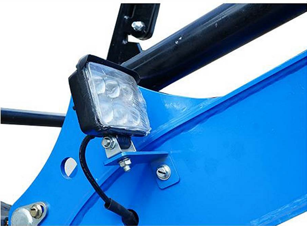
9 LED Light поставляется в стандартной комплектации со светодиодной подсветкой, которая выделяет мало тепла и устойчива к вибрации.
