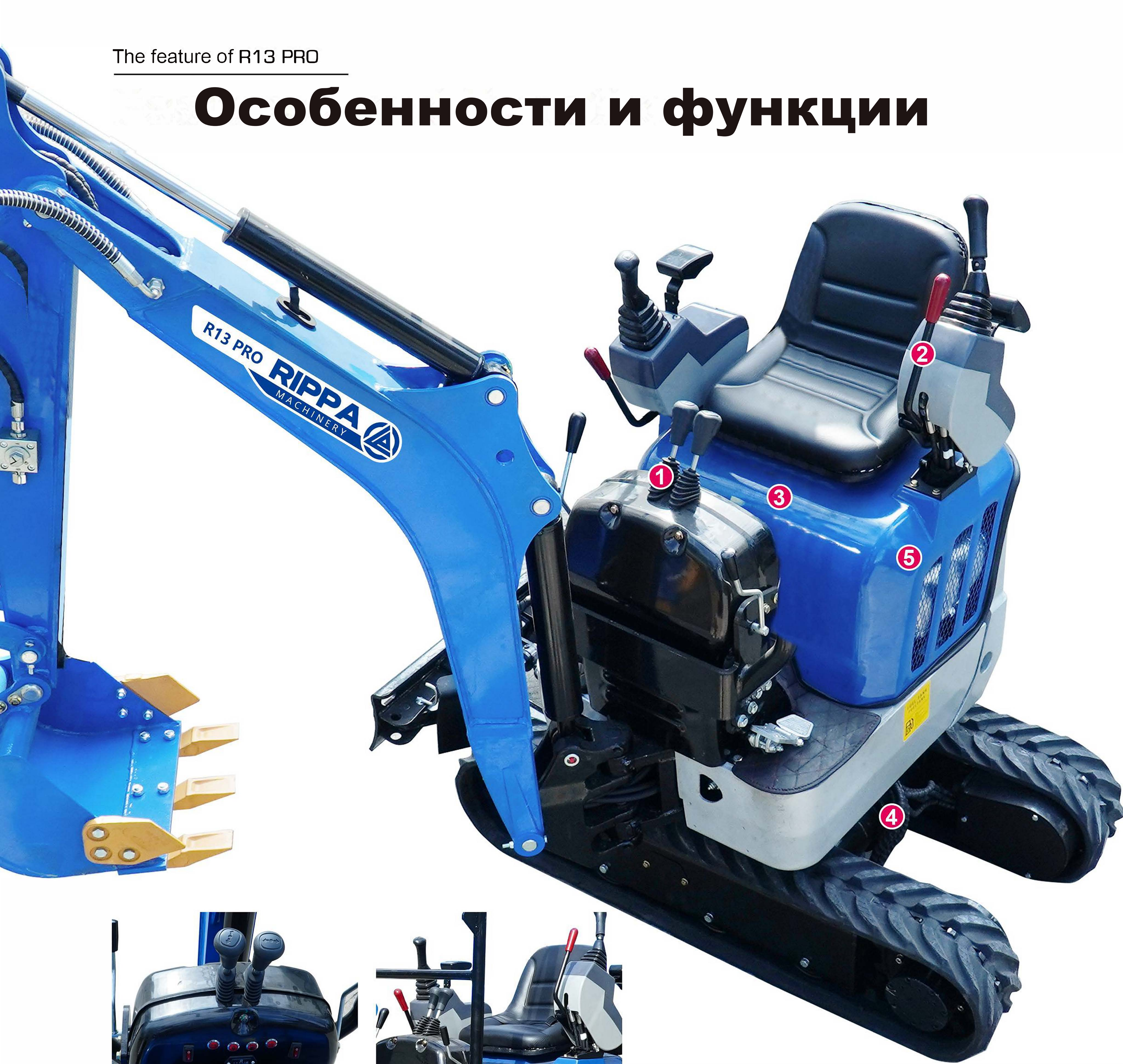
2 Рычаг блокировки управления оснащен функцией нейтрального запуска двигателя, которая предотвращает запуск двигателя, если рычаг блокировки управления не находится в поднятом положении.
