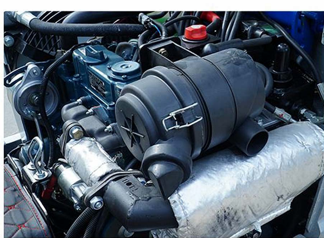
5 Воздушный фильтр Предотвращает попадание пыли и загрязнений в систему впуска воздуха двигателя, тем самым продлевая срок службы двигателя
