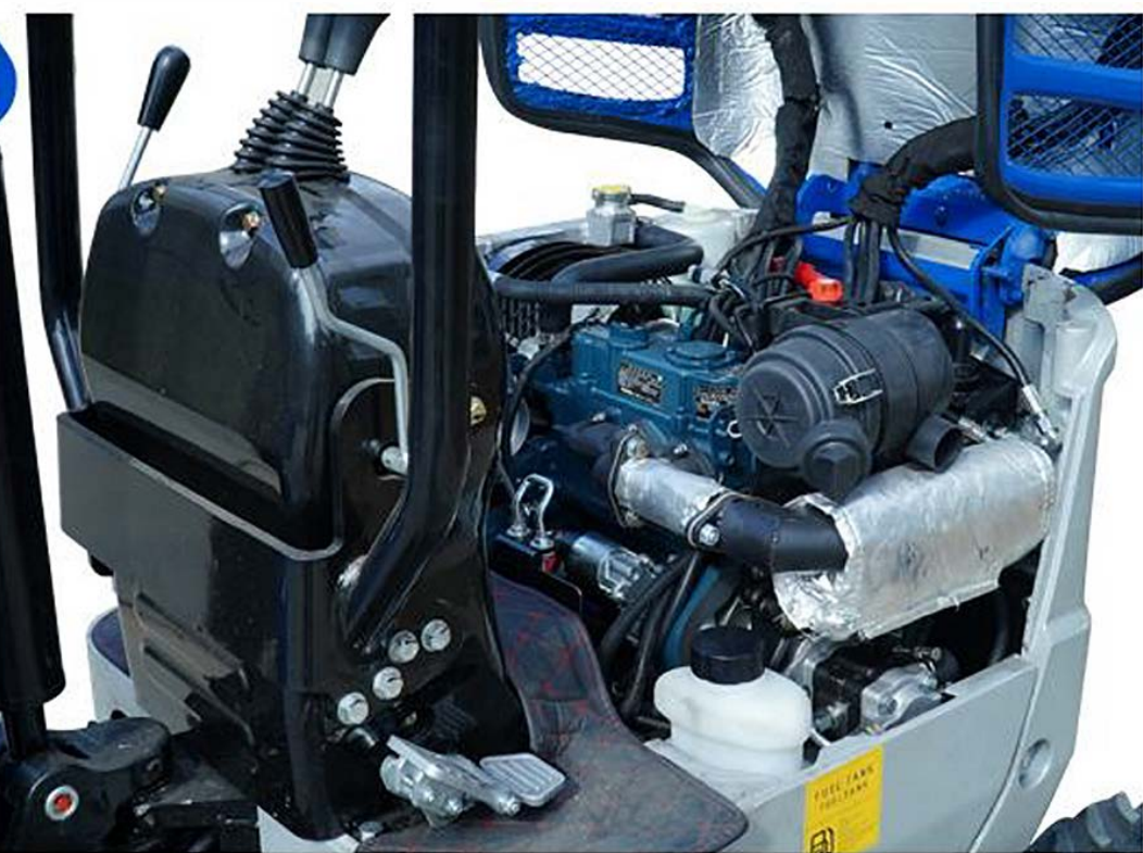
3 Полностью открывающийся капот Полностью открывающийся капот открывается назад, что облегчает проведение ежедневных проверок и замену деталей двигателя и топливной системы.
