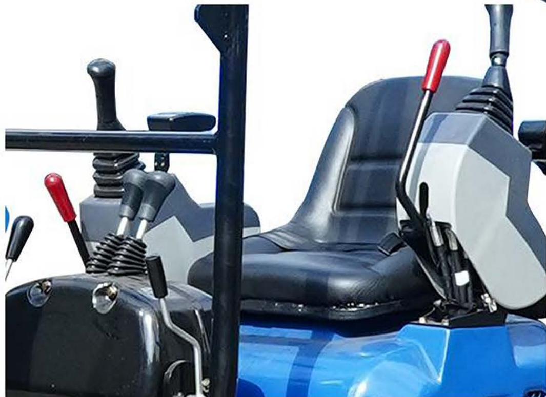
2 Рычаг блокировки управления оснащен функцией нейтрального запуска двигателя, которая предотвращает запуск двигателя, если рычаг блокировки управления не находится в поднятом положении.
