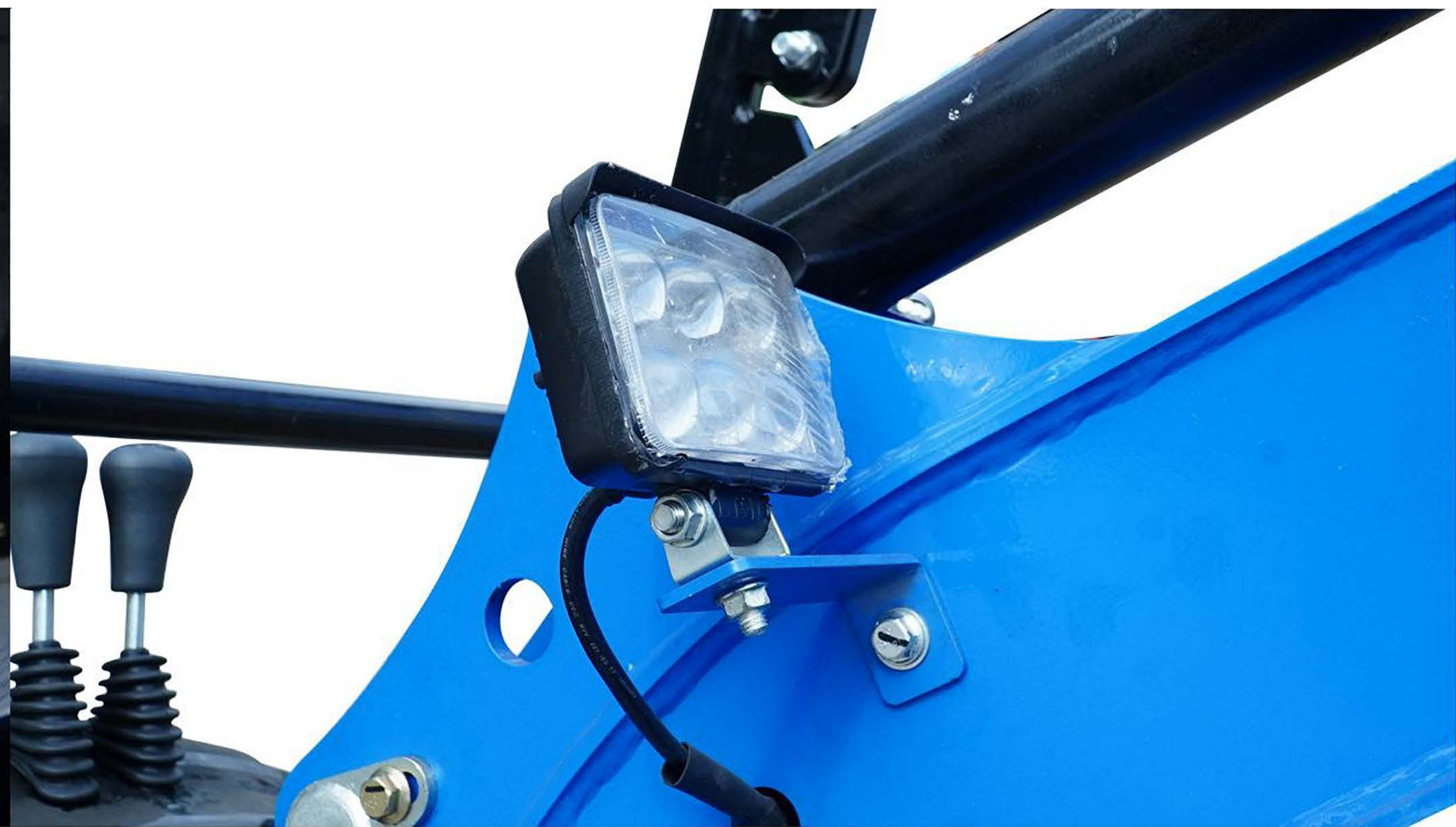
поставляется в стандартной комплектации со светодиодной подсветкой, которая выделяет мало тепла и устойчива к вибрации,
