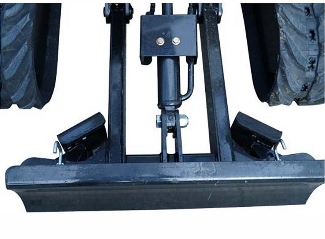
7 Extended bulldozer blade Ширина бульдозера может быть легко увеличена путем снятия и установки штифта.
